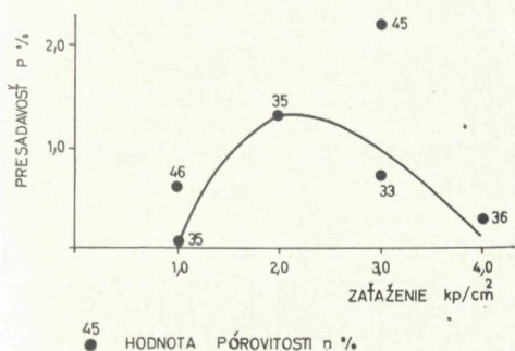
Obr. 14. Závislosť presadavosti na -zaťažení Fig. 14. Dependence of resettling on loading
